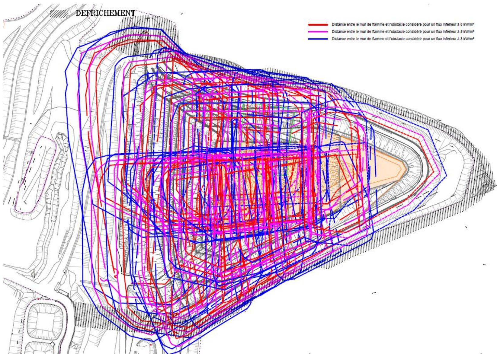
Figure 11 : Zones d'effets des flux thermiques sur l'ensemble de l'ISDND
